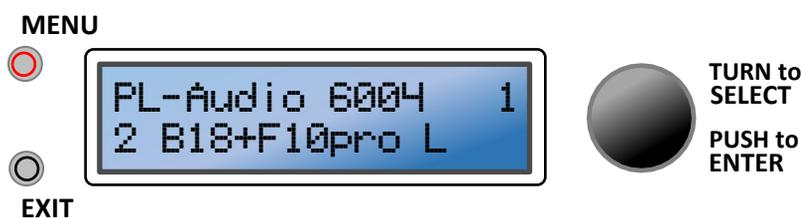
Obere Zeile: Benennung des PowerPacs bzw Modulblocks **PL-Audio 6004 1**
